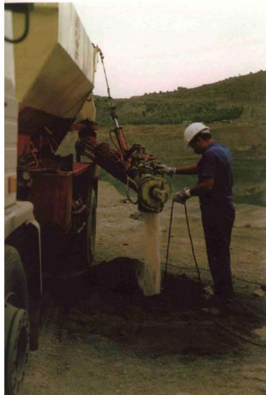
Camión de Nagolita para barrenos de gran calibre
