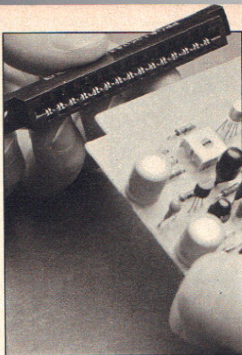
Il pettine dorato della scheda MPU si adatta ad un connettore 15 poli passo 3,96 mm.
