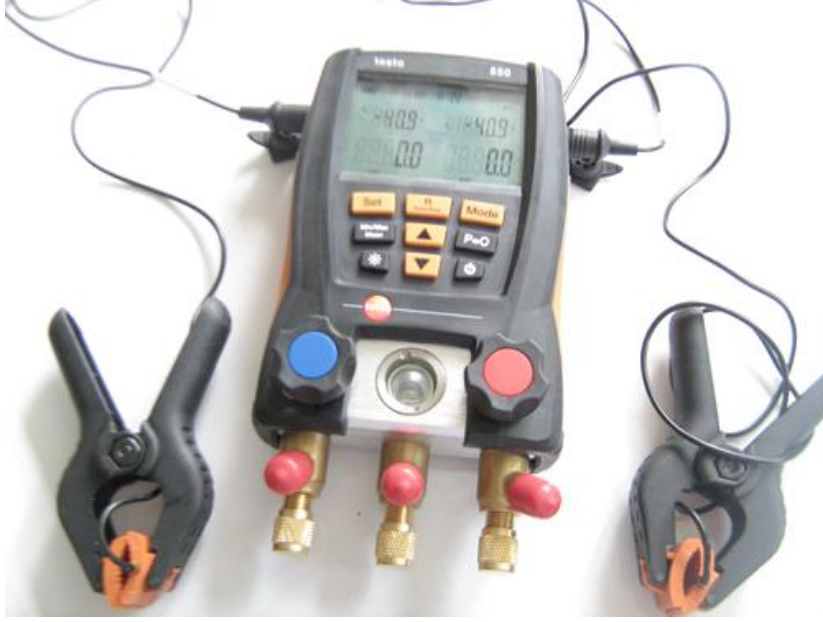
Resim 1.8: Dijital gaz manifoldu
