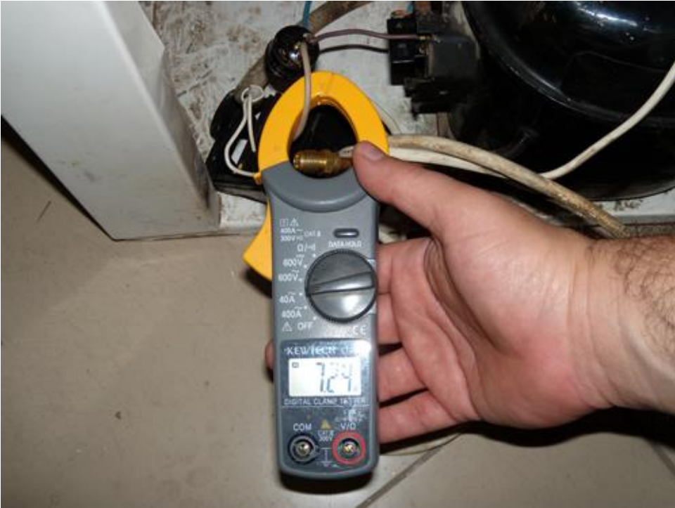
Resim 3.4: Pens ampermetreyle kalkış akımı ölçümü
