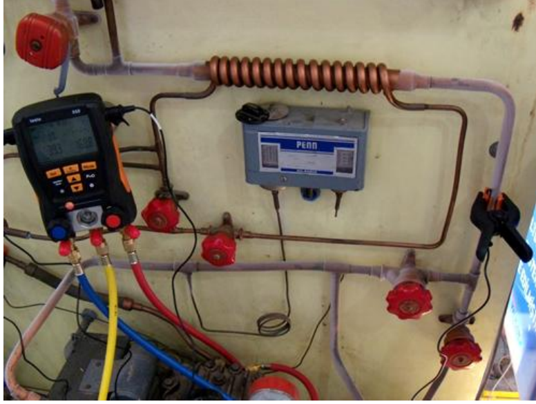
Resim 1.10: Evaporatör ve kızdırma sıcaklığı (superheat) ölçümü
