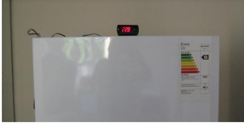
Resim 1.11: Kabin İçi Sıcaklık Ölçümü
