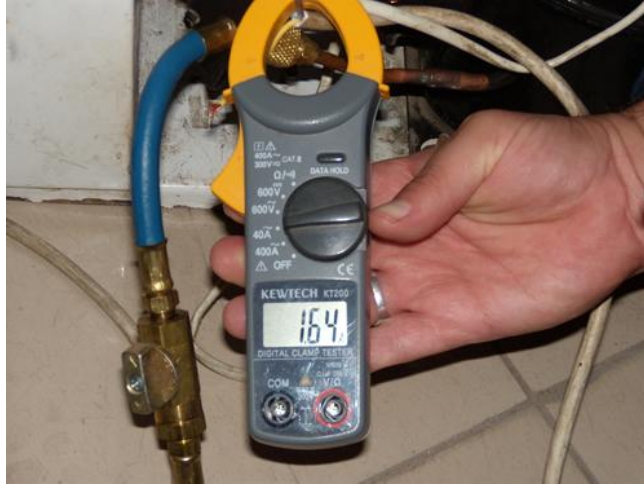
Resim 3.4: Pens ampermetreyle daimi çalışma akımı ölçümü
