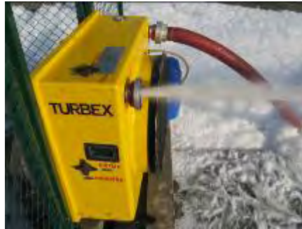
(resim 8.64) Turbex ile Aspirasyon Uygulaması
