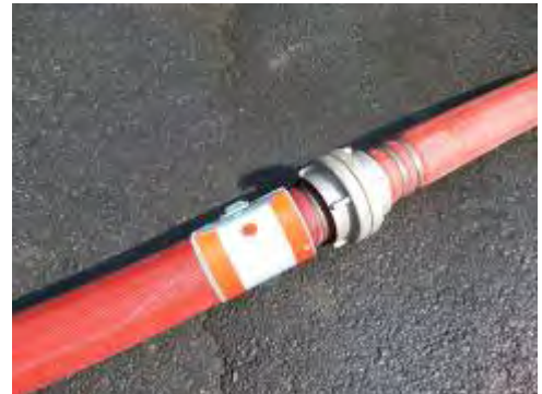
(resim 6.3) Çarık Uygulaması
