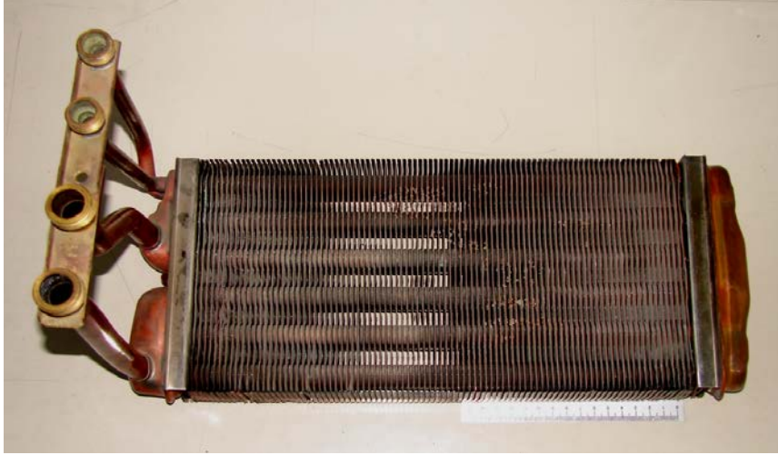
Resim 1. Ticari kanatçıklı borulu bir model ısı değiştiricisi
