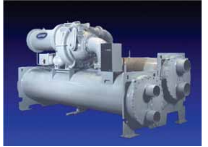
Resim 1- Carrier 19 XR Tek kademeli, yarı-hermetik, santrifüj kompresörlü su soğutma grubu [6]
