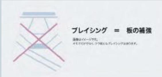
ブレイシング(力木)とはアコースティックギターの裏側に接着してある補強の木を指します。4枚の板で形作られるボディ部の強度を補完するだけでなく、ギターの音質にも影響する重要な箇所です。
