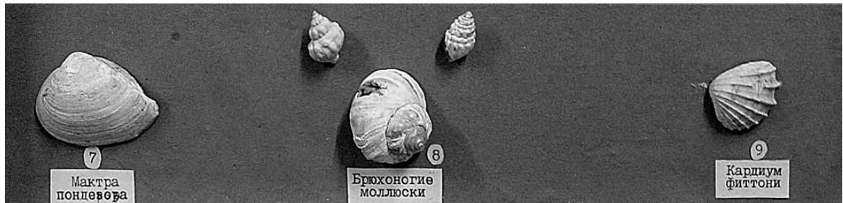
Раковины брюхоногих моллюсков, моллюсков рода мактра и кардиум, из которых состоит ставропольский ракушечник.
