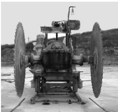
Современная камнерезная машина в пелагиадском карьере.
