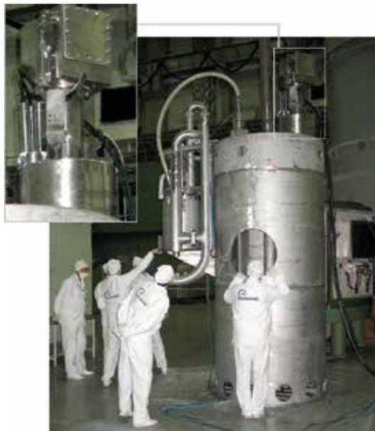
На Нововоронежской АЭС установка для УЗ-очистки тепловыделяющих сборок
