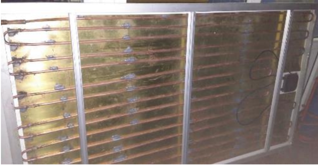
Şekil 3.1 PVT arka yüzeyi ve akışkan boruları
