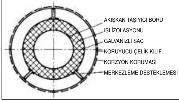
Şekil 4.21 / ÇELİK KORUYUCU BORULU KIZGIN SU BORUSU
