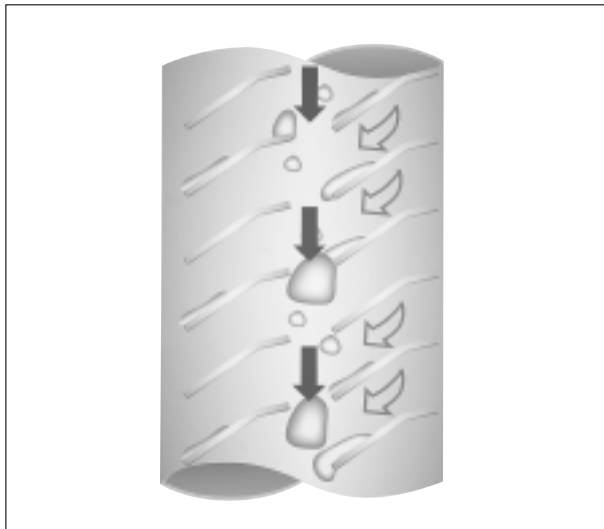
Şekil 3.49. TURBO-KONDENS - ISITMA YÜZEYİNİN ETKİME PRENSİBİ
