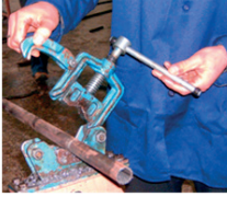
Borunun mengeneye bağlanması
