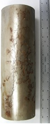
Şekil 13. Klorid Gerilim Korozyon Çatlağına maruz kalmış östenitik paslanmaz çelik boru (NACE)
