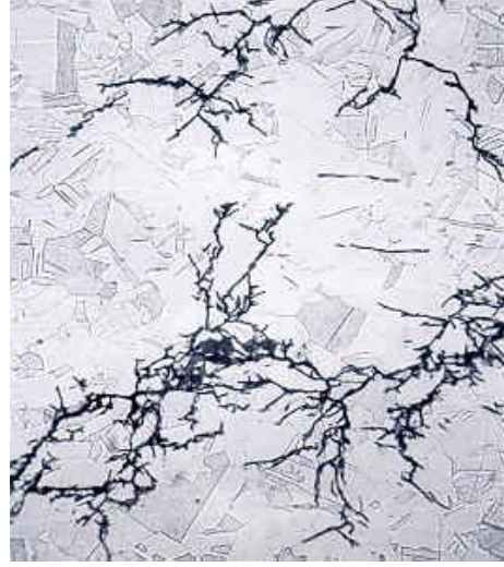
Şekil 14. 316 paslanmaz çelik kimyasal proses boru sistemi. Östenitik paslanmaz çelikte klorid gerilim korozyonu çatlağı - yıldırım- formunda çatlak oluşumu [5]
