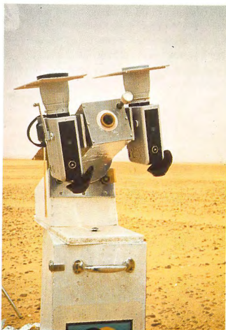
Die Transportkiste der elektronisch gesteuerten Nachführmontierung für die beiden Nizo S 800 diente zugleich als Stativsäule. An den Objektiven ist ein Strahlungsschutz angebracht.
