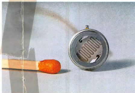
Ventilfunktion: CdS Fotowiderstand
