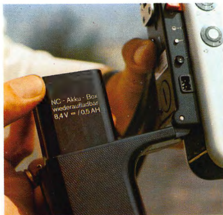
Die neue Braun Akku-Box paßt anstelle der normalen Batterie-Box in den Handgriff.
