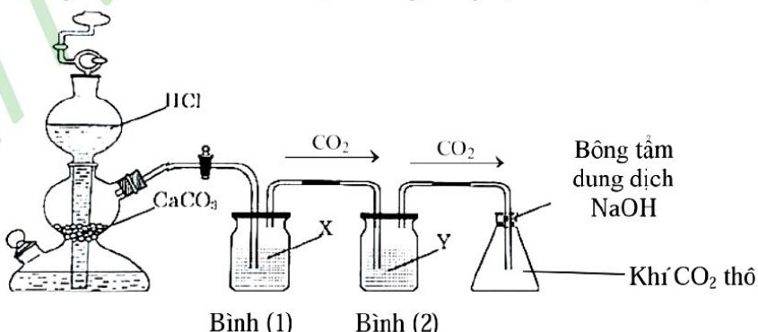
Khí  $\text{CO}_2$  sinh ra thường có lẫn hơi nước và hiđroclorua. Để thu được khí  $\text{CO}_2$  khô thì bình (1) chứa X và bình (2) chứa chất Y lần lượt là các dung dịch nào sau đây
