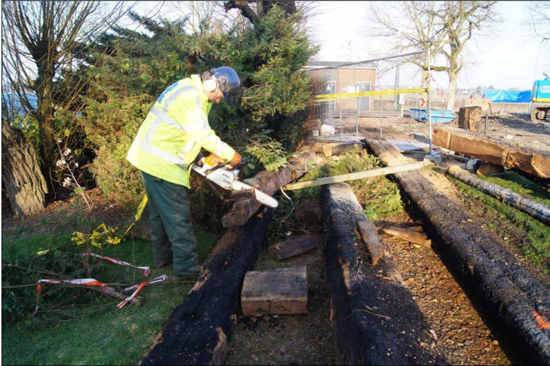
Afb. 61 Met een kettingzaag worden houtmonsters uit de balken gezaagd.
