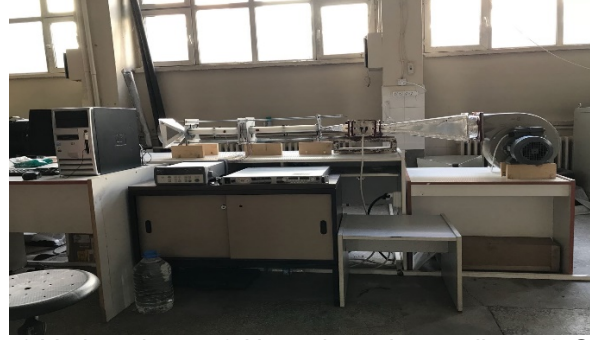
Şekil 2. a) Deney düzeneği şematik gösterimi 1-Veri toplayıcı 2-Hava hız ölçüm cihazı 3-Güç sabitleyici 4-Yaprak rezistans 5-Fan hız kontrol cihazı 6-Radyal Fan 7-Fan kanal arası bağlantı 8-Yaprak rezistansın bulunduğu kanal 9-Kanal kesit alanı düşürücü 10-Test bölümü giriş 11-Test bölümü 12-Test bölümü çıkış 13-Kanal kesit alanı yükseltici b) Deney düzeneğine ait bir fotoğraf
