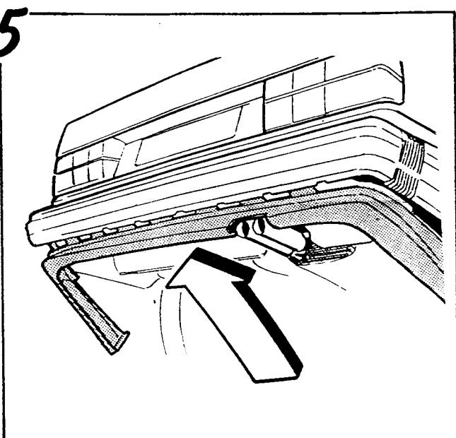
Skjut in bakspoilem under stötfångaren (mellan stötfångare och täckplåt).
