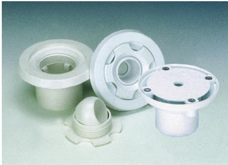
Oynak küresel başlıklı tipte yandan besleme nozulları Nozullarda su çıkış hızı 5 ila 7 m/saniye
