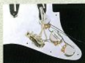
ELECTRIC CIRCUIT 配線材: ベルデン #8523 コンデンサー: VITAMIN-Q (オイル) セレクタスイッチ: DRL (5Way) アウトプットジャック: スイッチクラフト
