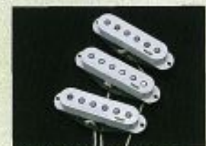
LOUIS PICKUP RVS-1 張りのある中音域とハイフーン時に於いても輪郭のはっきりとしたサウンドが特徴です。リアポジションにおいては音やせが無く、抜けるようなアタックを感じる事ができます。 ターン数: 8000ターン (エナメル線使用) マグネット: アルニコ5
