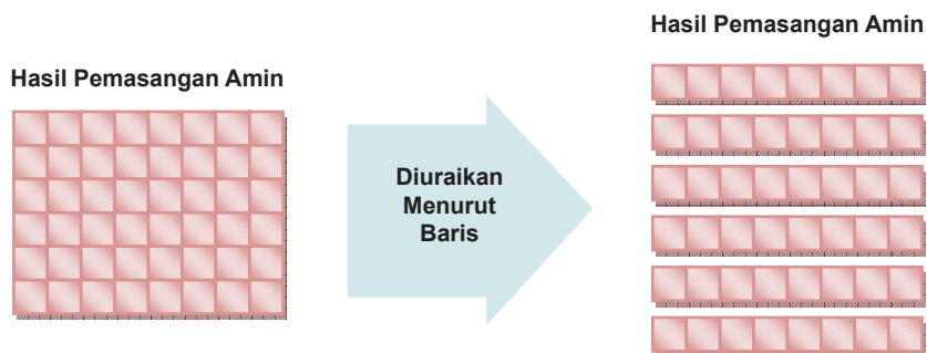
Gambar 2.13: Pemasangan Ubin Amin
