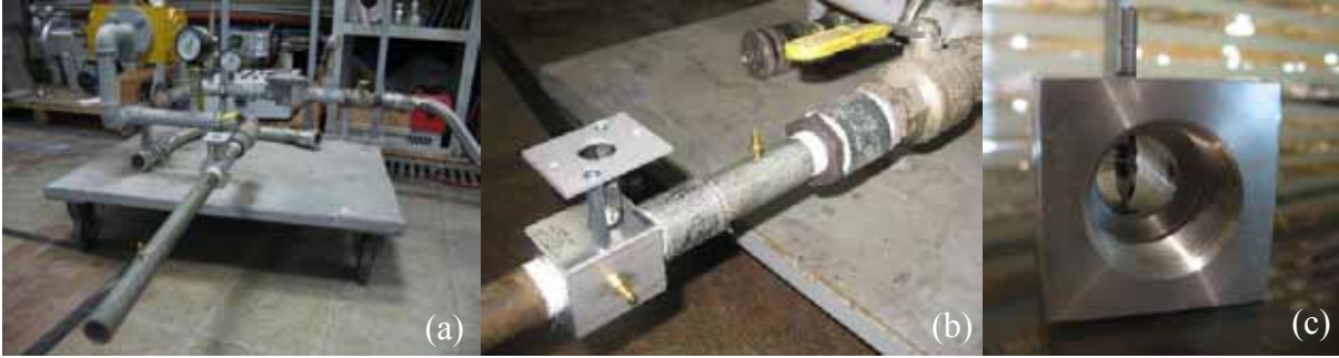
Şekil 2. Hava ile boğulma deneyi ekipmanları. a,b) Düzenek, c) Dairesel kelebek vana.
